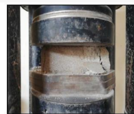
Rajah 3 : Ujian mampatan
